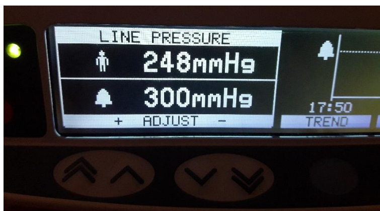
Slika 3: Merjenje linijskega tlaka v posebnem balončku
